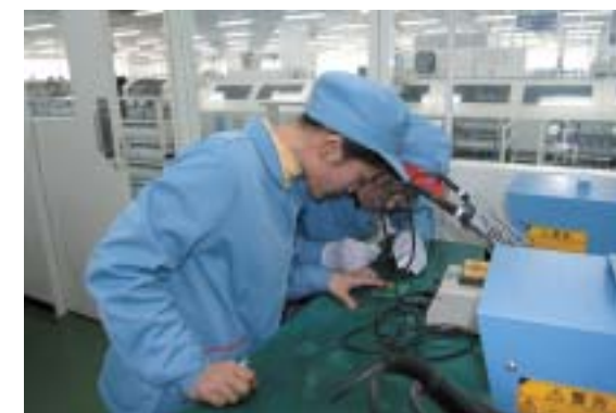
▲MDI正在推广在基板上使用的软焊料的无铅化。由于无铅化的焊接需要一定的技术,熟练工人要对新手进行指导。
